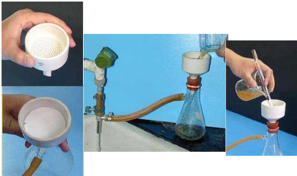
实验室常见的过滤装置
