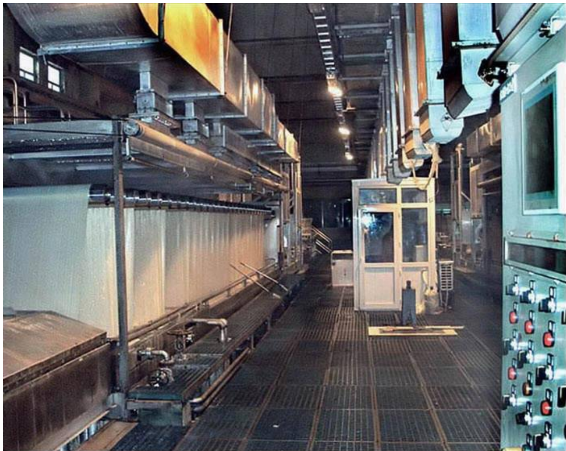
图 4.16 聚丙烯腈纤维的水洗定型
