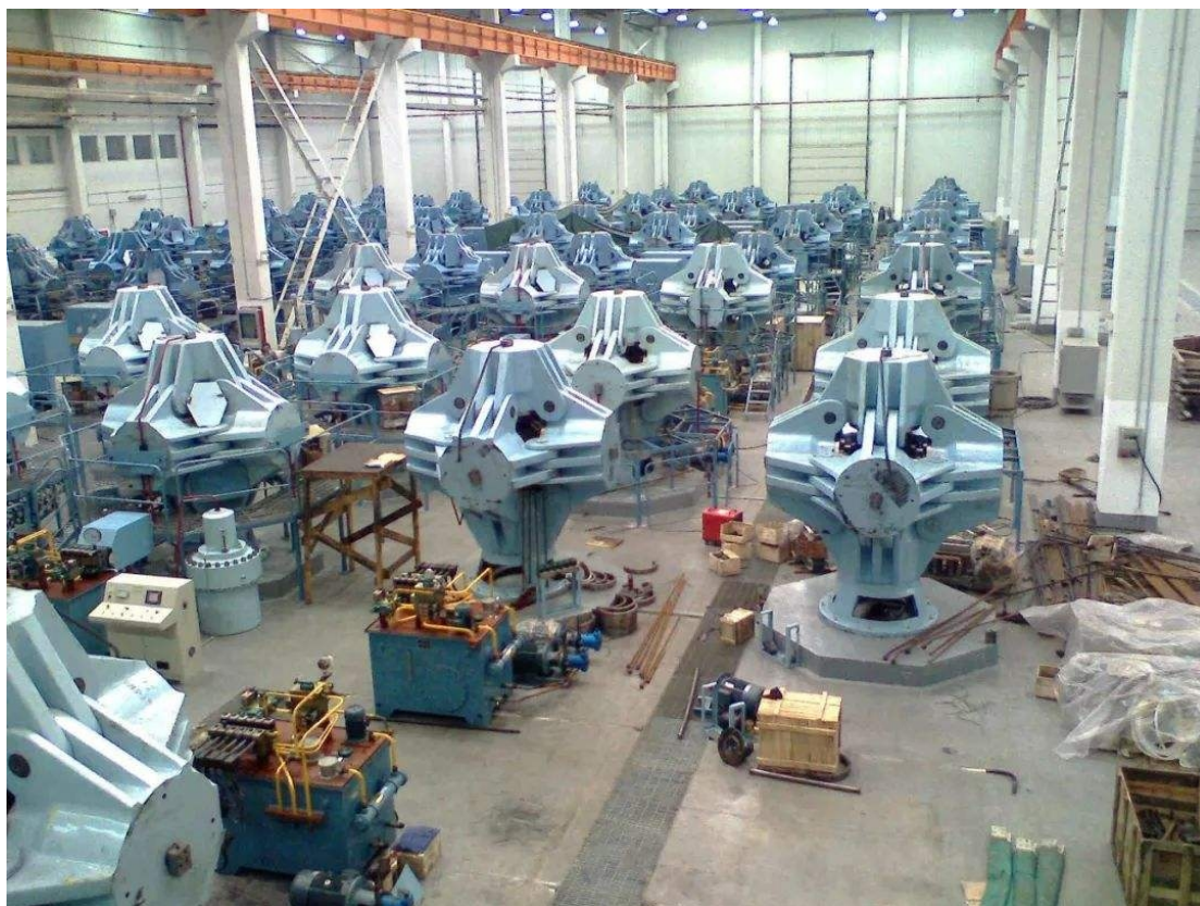
图 9.1 高温高压法生产人造金刚石的六面顶压机
