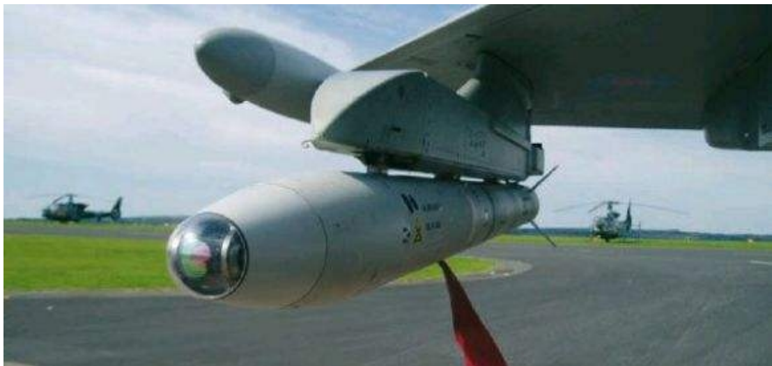
图 9.5 纳米人造金刚石薄膜镀膜导弹红外窗
