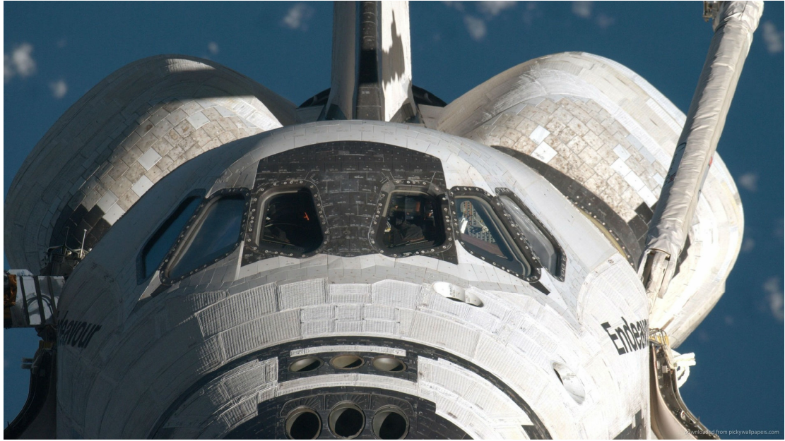
图 2.5 航天飞机的陶瓷外衣
