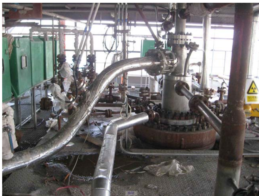
图 5-53 德士古气化炉
