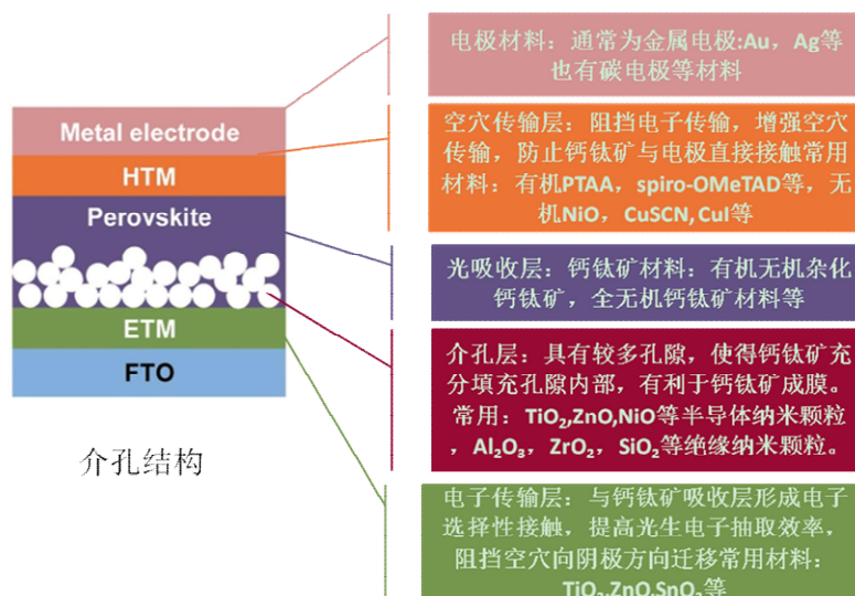
钙钛矿太阳能电池工作原理图
