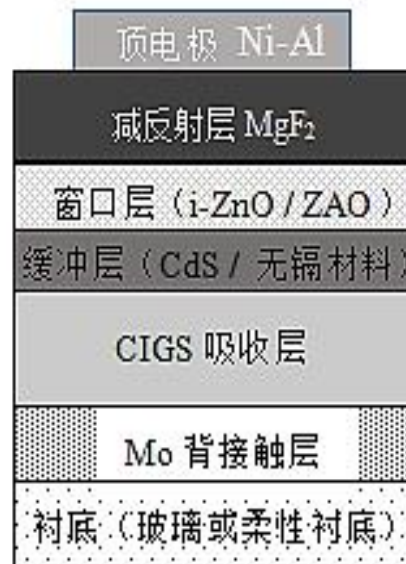
CIGS 薄膜太阳电池典型结构
