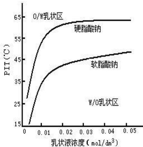
图 离子型表面活性剂 (A) 硬脂酸钠和 (B) 软脂酸钠浓度与相转变稳定间关系
