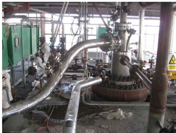
图 5-53 德士古气化炉
