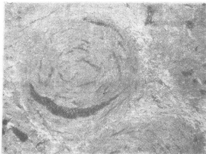
图 2.7 石墨化冶金焦的球状体和片状体（ \times 300 ）
