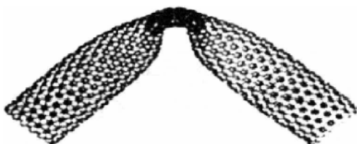
图 4.17 单壁碳纳米管在大角度弯曲下的变形
