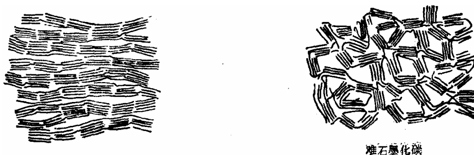
图 1.12 易石墨化碳结构模型
