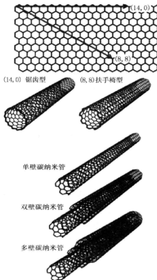
图 4.10 碳纳米管的结构分类
