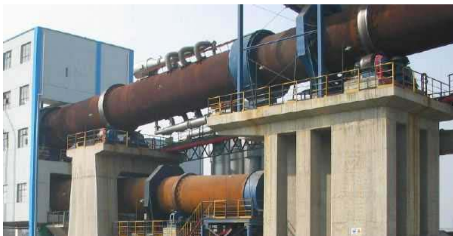
图 7.4 回转窑煅烧
