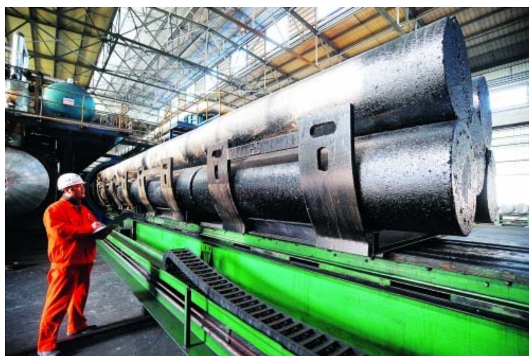
图 7.7 石墨电极的浸渍
