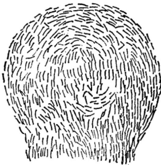
图 6-2 炭黑的同心取向准石墨结构
