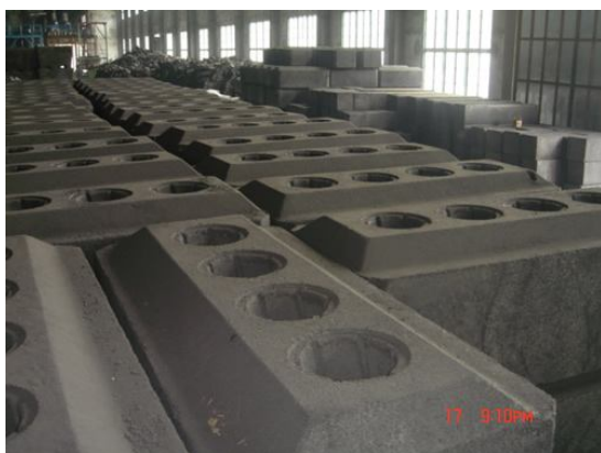
图 1.2 铝电解厂的石墨阳极
