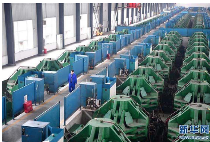
图 10.3 六面顶压机生产人造金刚石
