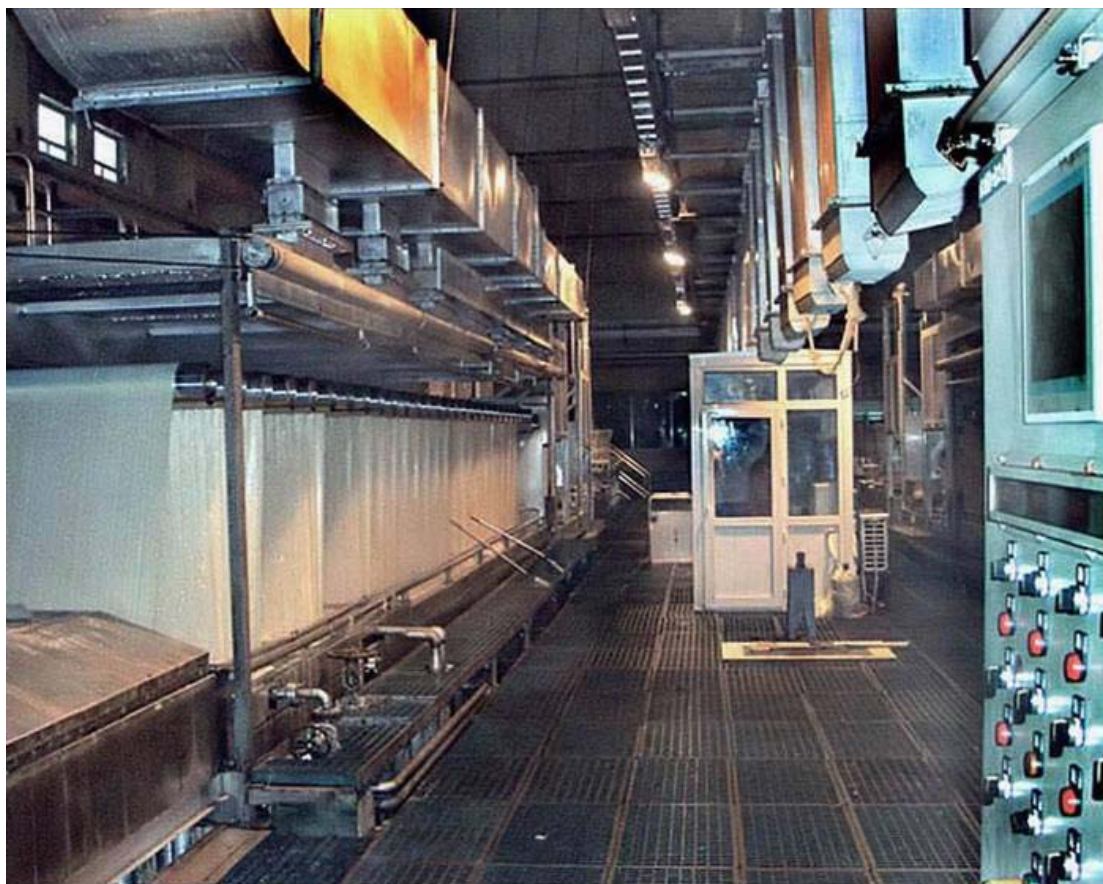
图 4.16 聚丙烯腈纤维的水洗定型
