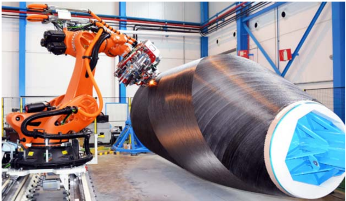
图 2.6 碳纤维复合材料缠绕小型飞机座舱
