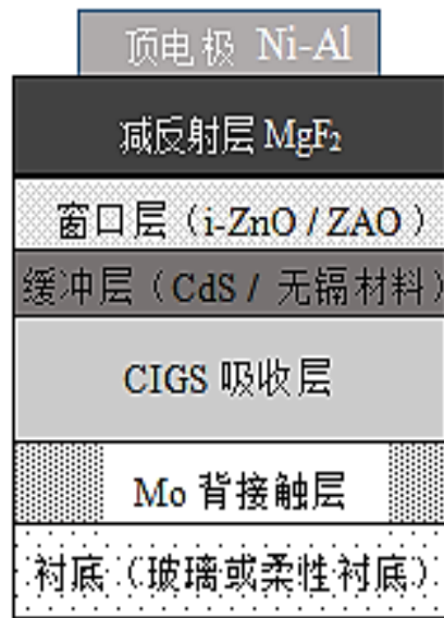
CIGS 薄膜太阳能电池典型结构
