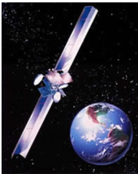
图 7.1 碳纤维复合材料在卫星太阳能电池板支架上的应用
