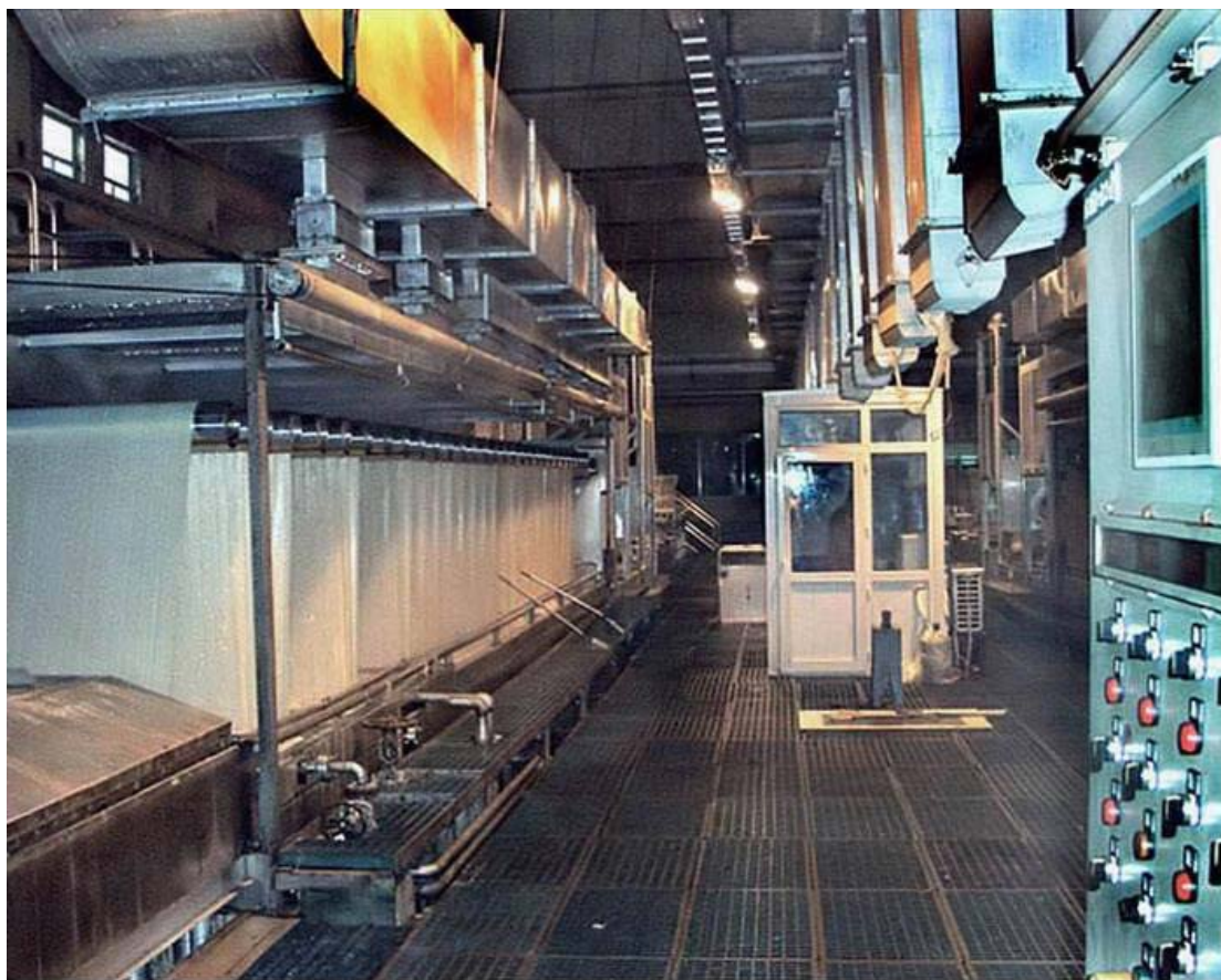
图 4.16 聚丙烯腈纤维的水洗定型
