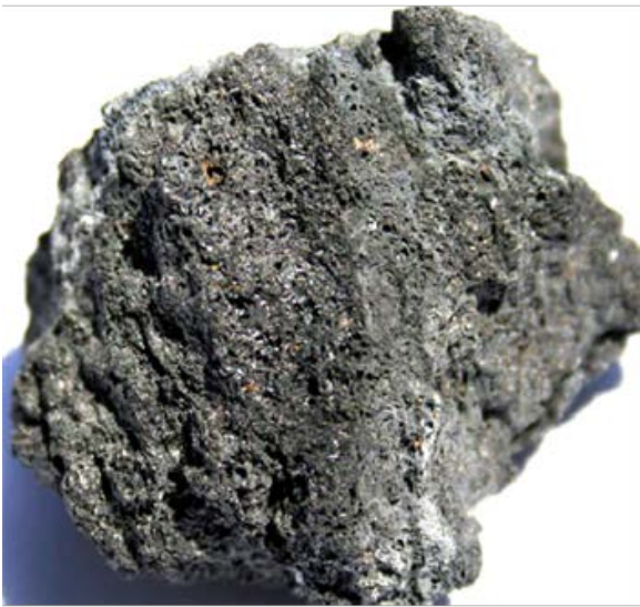
图 3-41 焦炭的气孔 图 3-42 焦炭的裂纹形成
