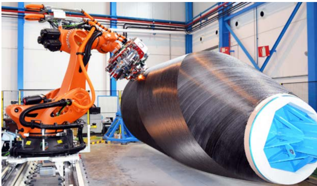
图 2.6 碳纤维复合材料缠绕小型飞机座舱
