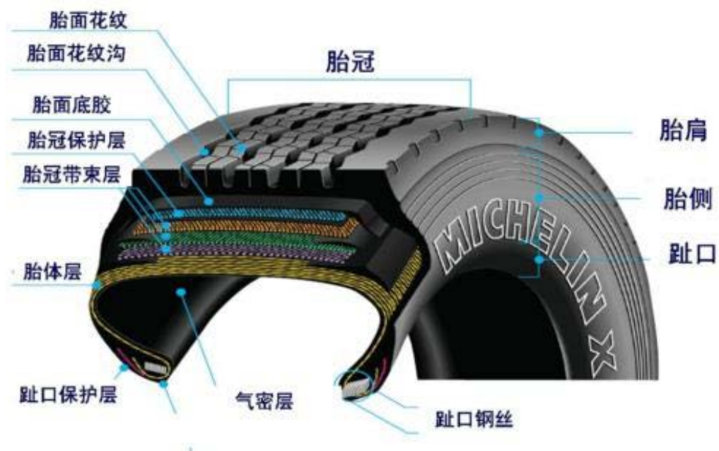
图 2.4 复合材料——轮胎的结构
